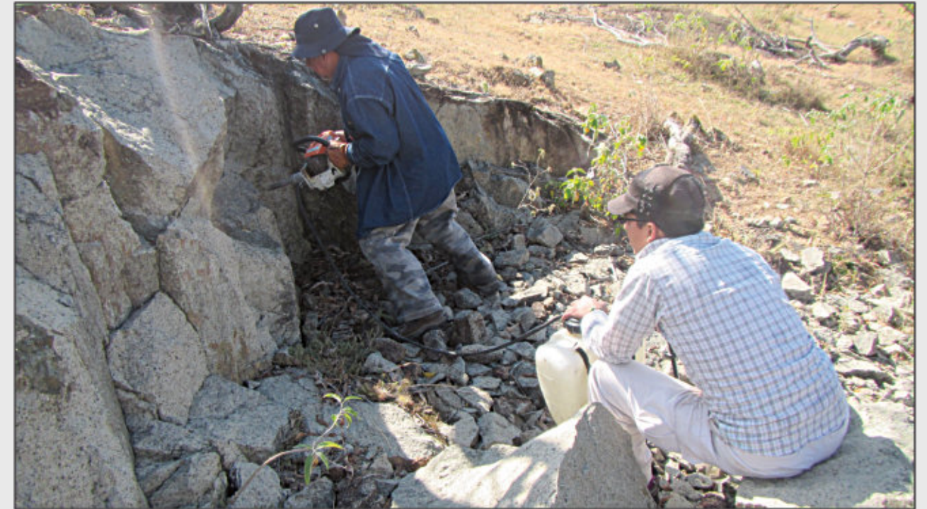
Figura 2. Muestreo paleomagnético con perforadora de gasolina. Mientras una persona bombea el agua a la perforadora, la otra persona perfora un núcleo de roca de ~12 cm de largo por 1" de diámetro.
