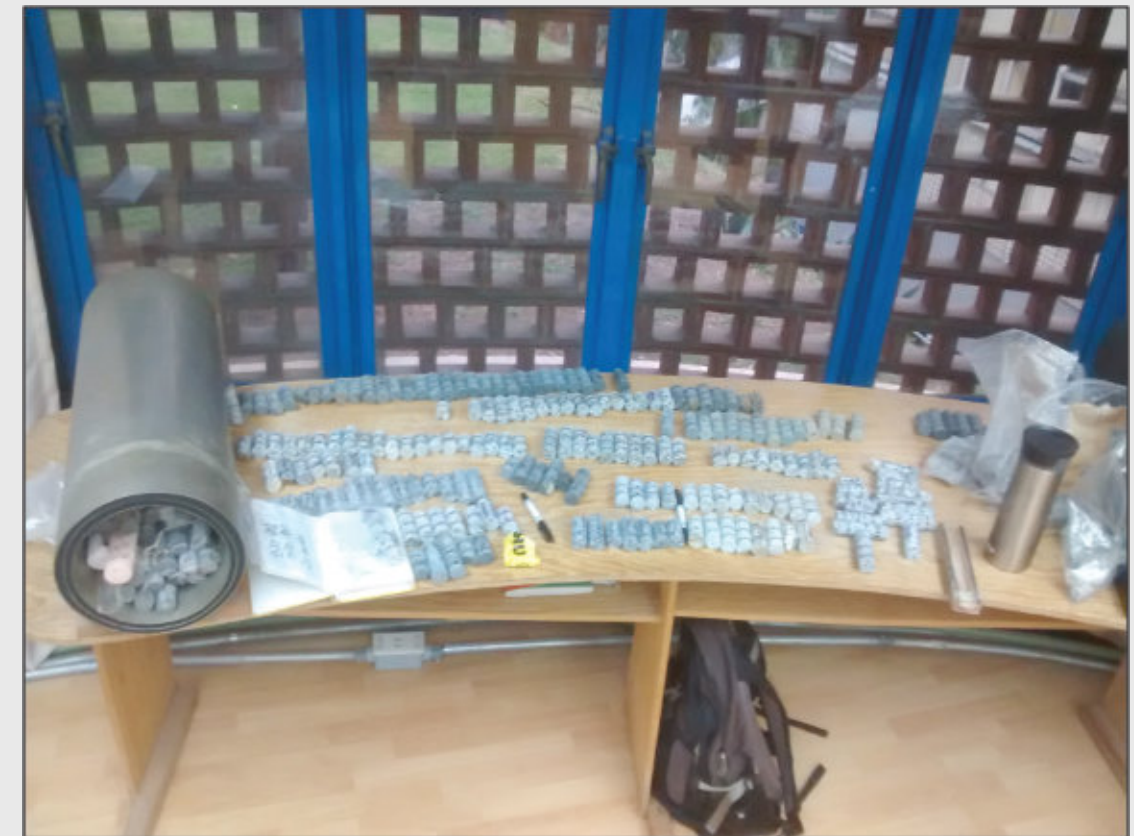
Figura 3. Preparación de muestras, núcleos perforados, en el LP-CU antes de ser analizadas en los equipos de paleomagnetismo.
